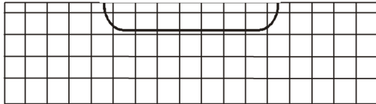
Figura 5.1. Generarea gridului rectangular uniform în cazul joncțiunii pn planare
